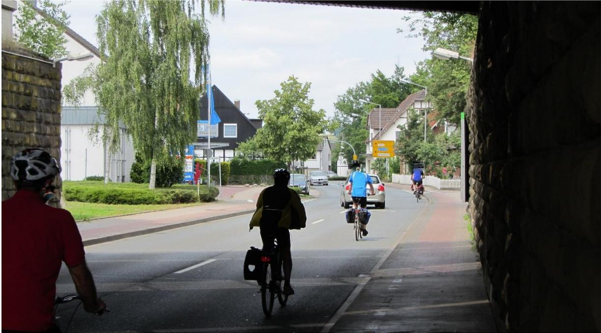
Abbildung 3 Bahnunterführung Herforder Straße / Kölner Bahn – Sichere Verkehrsführung für Radfahrer gut sichtbar auf der Fahrbahn und abseits der in den Geh- und Radweg hineinragenden Bruchsteinelemente. Keine Konflikte mit Fußgängern.
