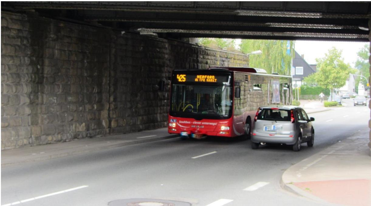
Abbildung 2 Bahnunterführung Herforder Straße / Kölner Bahn – fehlender Abstand breiter Fahrzeuge zu Gehwegen
